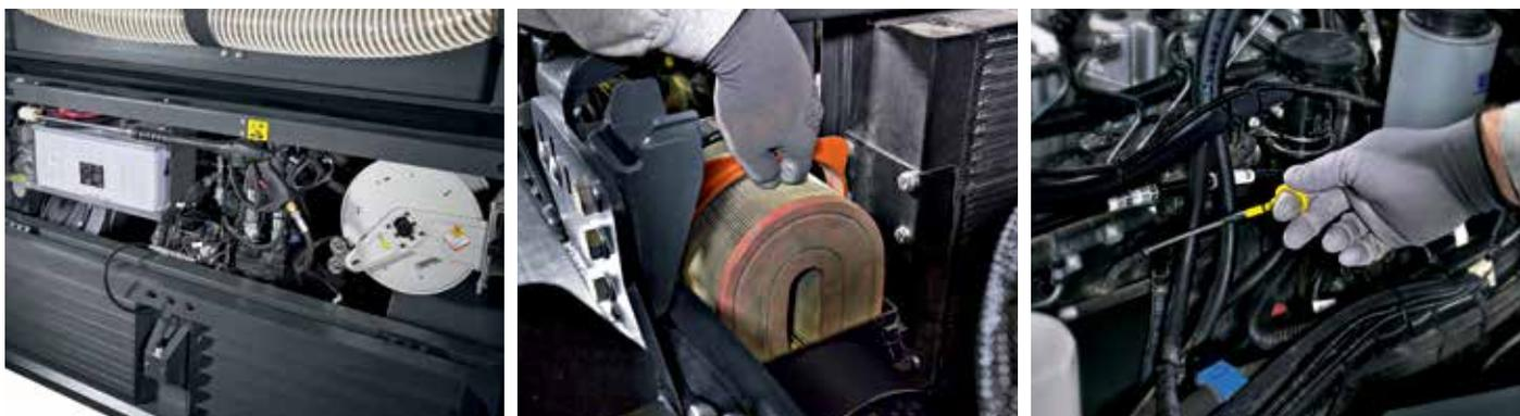
El filtro del aire motor y el radiador de aceite hidráulico están colocados en la parte trasera de la máquina y son accesibles por una puerta que se puede abrir también con el cajón bajado. En esta posición son
