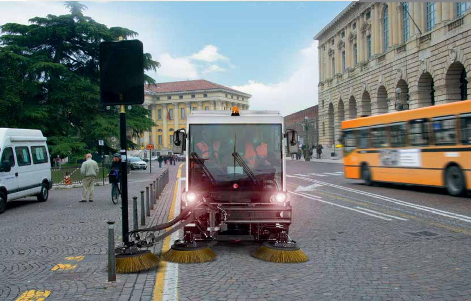
Comac ha creado un dispositivo especial de control que, interviniendo por separado en las cuatro ruedas, mantiene constante la altura de la máquina del suelo, también cuando se varía la carga, optimizando así el trabajo y la estabilidad.
