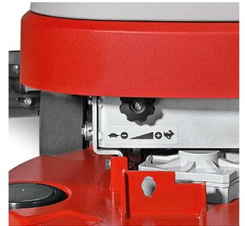
El cepillo se ajusta fácilmente sin herramientas para adaptarse a cualquier pavimento
