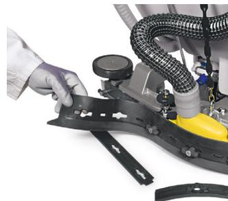
Las operaciones de sustitución y rotación de las gomas de la boquilla de aspiración se realizan en pocos instantes y no requieren el empleo de herramientas
