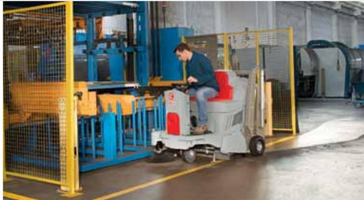
CS700/800 B-H son barredoras operador a bordo de tracción automática, disponibles con alimentación a baterías o con motor de gasolina, realizadas en las versiones de 70 y 80 cm de pista de trabajo (cepillo central).
