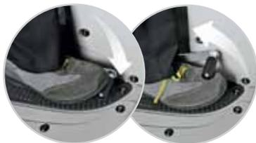
Los cepillos central y laterales son bajados/levantados simplemente mediante 2 palancas
