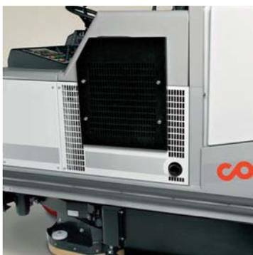
C130 Diesel - Radiador con ventilador soplador
