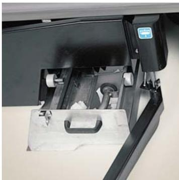
Los desechos son recogidos por el cepillo cilíndrico en un cajón de amplia cabida al efecto. La operación de vaciado se realiza fácilmente, extrayendo desde la parte inferior del lateral de la máquina, por medio de las guías de los cojinetes
