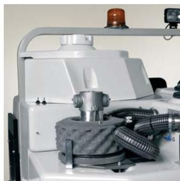
Motor de aspiración fácilmente accesible, puesto que el cárter protector es muy fácil de desmontar
