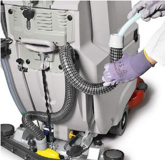
Para obtener un secado siempre perfecto es fundamental limpiar después de cada operación el tubo de aspiración y las gomas de la boquilla de aspiración. La boquilla se puede elevar para poder acceder fácilmente a las gomas y limpiar con rapidez
